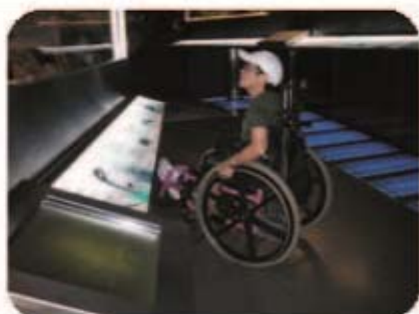
● 介紹濕地資料的資料板適合輪椅使用者的角度
